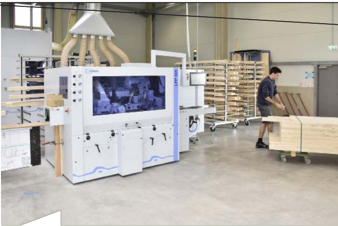
Nestle zählt auch bei der neuen Homag-Hobelmaschine zu den ersten Kunden. Seit Januar ist hier die Mouldteq M-300 mit fünf Spindeln im Einsatz.
